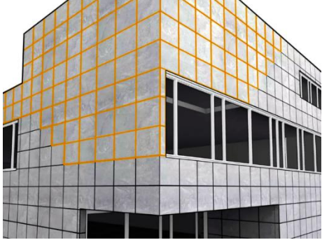
Герметизация швов в стеновых фасадных панелях
