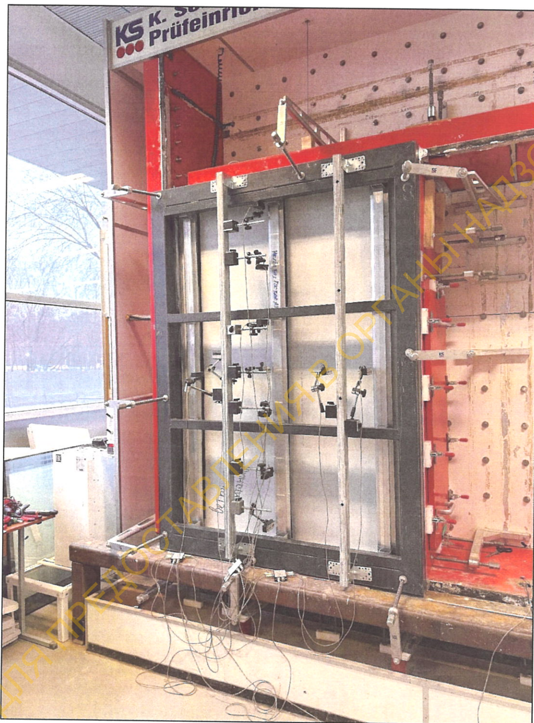
Рисунок 1– Образец 1134-24, установленный на испытательный стенд
